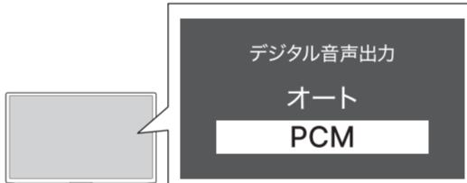
※音が出ない場合、テレビのデジタル音声出力をPCMに設定してください
